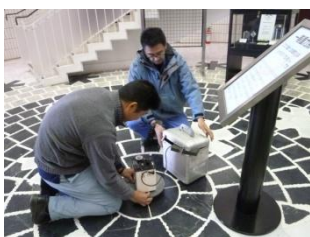
一等重力点に測定器を慎重にセットします
